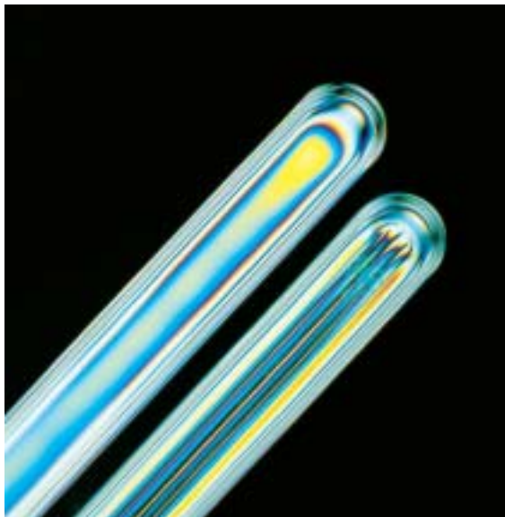
KLINGER Transparentglas (links) und Reflexionsglas (rechts) im polarisierten Licht
